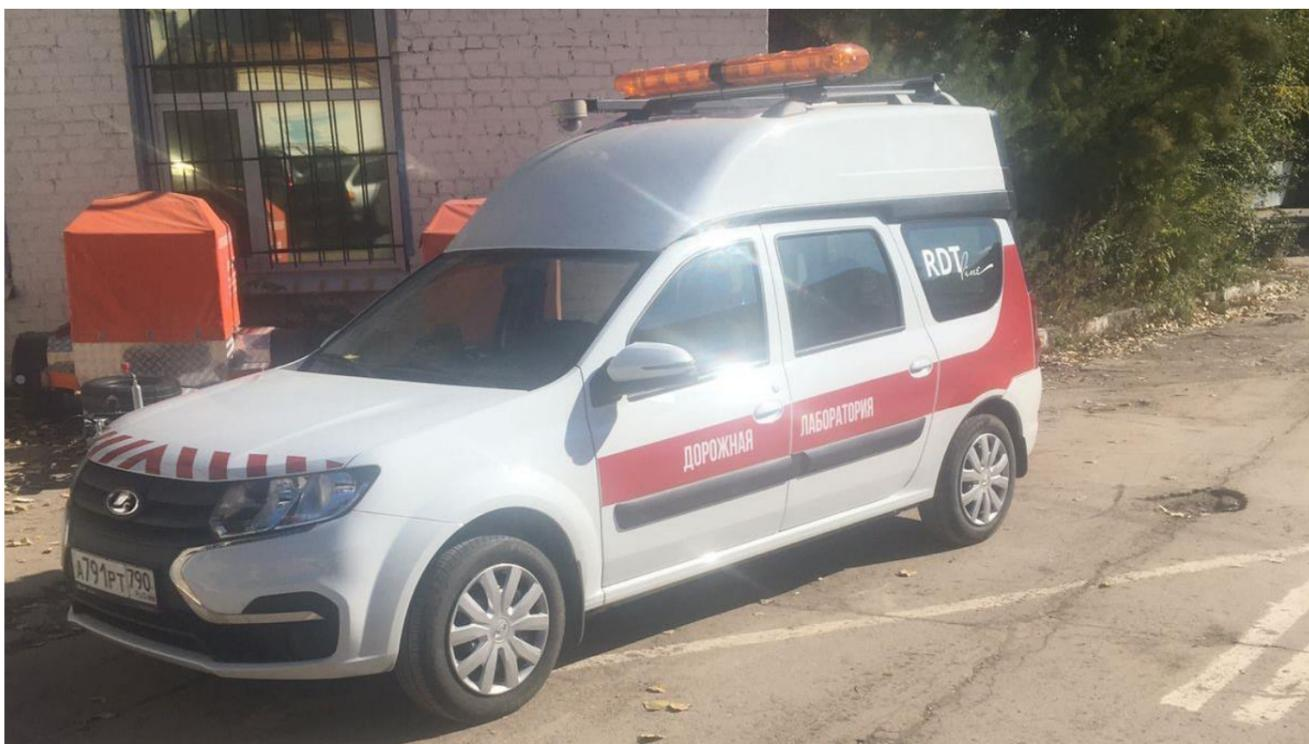
Рис. 1. Комплекс измерительный передвижной дорожной лаборатории «КП-514»
